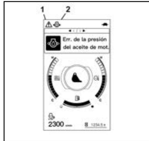
Al presentarse un error en el sistema de carga durante el servicio hay que parar el motor inmediatamente. El testigo de control de carga (2) está encendido, el testigo de aviso (1) parpadea con luz roja, y en el visualizador aparece el mensaje que se muestra en la imagen de la derecha.
