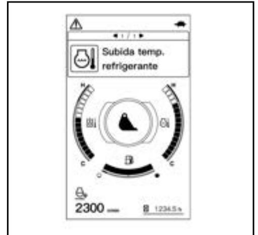
Si la temperatura del líquido refrigerante es demasiado alta, dejar la máquina a ralentí para facilitar su enfriamiento. El visualizador muestra un mensaje como el de la imagen de la derecha.
