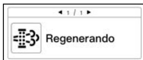
La temperatura de los gases de escape aumenta durante la regeneración del filtro de partículas. No obstante, la máquina se puede seguir utilizando.
