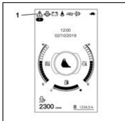
Al iniciarse la regeneración automática del filtro de partículas, el visualizador indica el mensaje que se muestra en la imagen de la derecha. Además, el testigo de aviso parpadeará en color amarillo y sonará una señal acústica cada 60 segundos.
