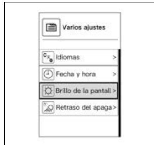
El ajuste de brillo "Día" se aplica al trabajo con los faros de trabajo apagados, mientras que el ajuste "Noche" se utiliza para el trabajo con ellos encendidos.
