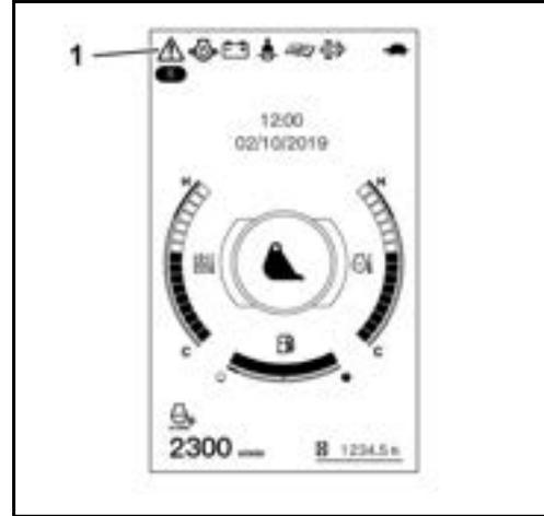
Si no hay suficiente presión del aceite de motor durante el servicio hay que parar el motor inmediatamente. El testigo de control de presión del aceite de motor (2) está encendido, el testigo de aviso (1) parpadea con luz roja, y en el visualizador aparece el mensaje que se muestra en la imagen de la derecha.
