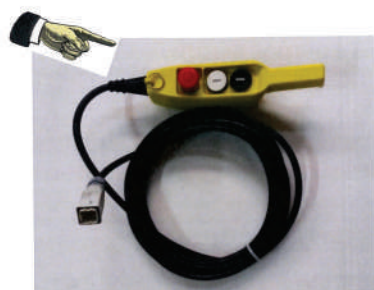
Pulsador de "Parada de emergencia" en el mando de control.
