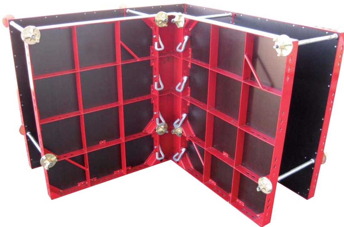
Sistema de Encofrado Fenolico Serie Ligera para la realización de muros y para ser montado sin necesidad de grua, 33 Kg/m<sup>2</sup>.
