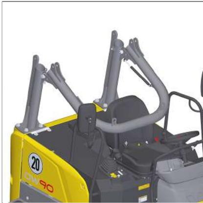
Fig. 87: Barra antivuelco plegada hacia abajo
