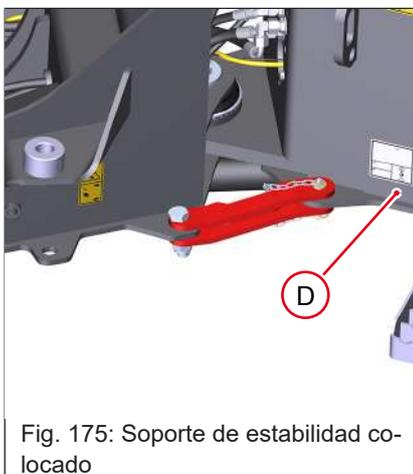
Fig. 175: Soporte de estabilidad colocado
