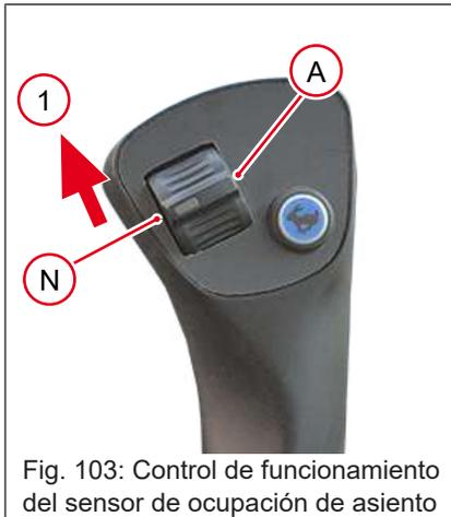
Fig. 103: Control de funcionamiento del sensor de ocupación de asiento
