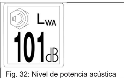
Fig. 32: Nivel de potencia acústica
