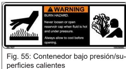
Fig. 55: Contenedor bajo presión/superficies calientes
