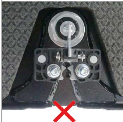
Fig. 187: Controlar la cerradura del capó (representación simbólica)
