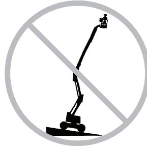
No confíe en la alarma de inclinación como indicador de nivelación. La alarma de inclinación sólo suena cuando la máquina se encuentra en una pendiente muy pronunciada.
