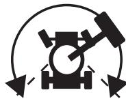
Para desplazarse, mantenga presionado el conmutador de activación de desplazamiento en cualquier sentido y aleje del centro lentamente la palanca de control.
