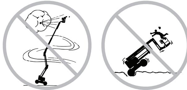
Cuando conduzca la máquina en posición replegada a través de terrenos irregulares, escombros, superficies inestables o deslizantes, o cerca de agujeros y pendientes, extreme las medidas de precaución y conduzca a baja velocidad.
