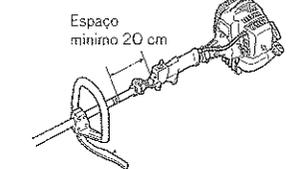
Monte el mango en el tubo del eje y suspenderlo en una posición cómoda para usted.
