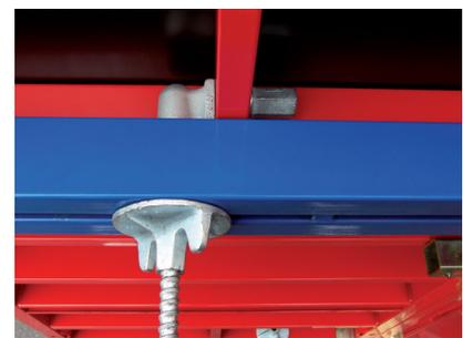
Las vigas rigidizadoras se quedan fijadas a los paneles mediante el herraje sujeción viga y dos tuercas, sin necesidad de desmontarlas cada vez que se desencofra.
