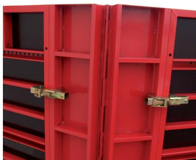
Las bisagras interiores y exteriores son utilizadas para resolver de forma sencilla ángulos variables que no tengan concretamente 90°, sujetándolas de igual forma con la Llave Alineadora.
