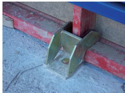
**MORDAZA DE ELEVACIÓN.** Elemento indispensable para el movimiento de pantallas de paneles con seguridad.
