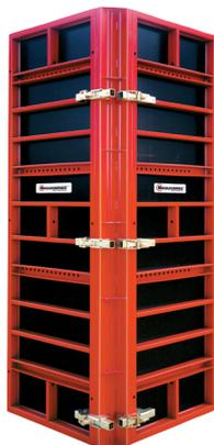
Con las escuadras interiores y exteriores unidas a los paneles mediante llaves alineadoras se pueden formar esquinas a 90°. Para formar diferentes grosores de muro compensaremos con paneles de anchos inferiores en la parte exterior del muro.
