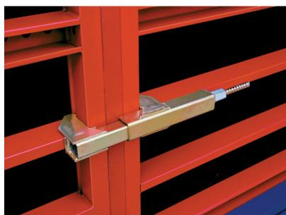
Existen tres tipos de compensadores, el Perfil de Compensación de 5 cm y el de 10 cm, que se colocan entre dos paneles y su sujeción mediante Llave Regulable y la Chapa de Compensación, que nos compensa hasta 25 cm. Esta Chapa lleva incorporados dos perfiles con tuerca vikingo para la sujeción a los dos paneles. Para darle mayor rigidez a la Chapa de Compensación deberemos hacer pasar una varilla diwidag por su orificio para soportar la compresión.
