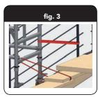
Deslice los soportes de rueda con tapa completamente en los soportes de un armazón de montaje de 4 peldaños y en los soportes del bastidor pasarela. Gire la tuerca de ajuste para ajustar la altura hasta 25 mm más de la posición más baja de la tapa.
