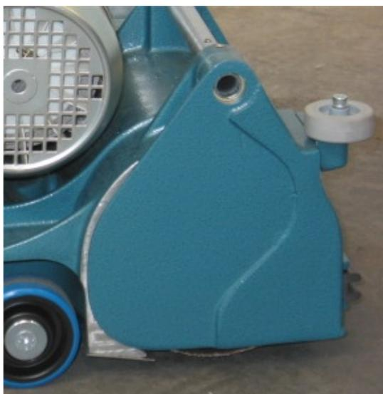
Per evitare, durante la levigatura a filo muro, danneggiamenti allo zoccolino o alla parete è stato montato un supportino con una rotella libera **pos. 6 fig. B**.
