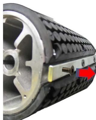
Inserire un'estremità dell'abrasivo **pos. 3 fig. D** sotto il premi-carta. Ruotare il rullo al fine di avvolgere l'abrasivo attorno al rullo stesso. Inserire l'altra estremità **pos. 4 fig. D** dell'abrasivo sotto il premi-carta. Centrare l'abrasivo sul rullo e tenderlo in modo da eliminare ogni grinza. Stringere accuratamente le viti del premi-carta. In caso di dubbio allentare le viti fissaggio premi-carta e ripetere la procedura.
