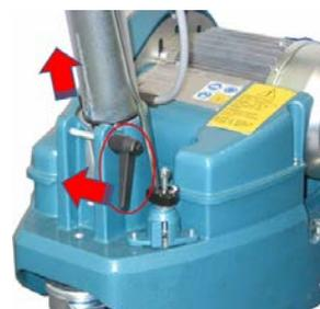
5. Sollevare il basamento afferrando nella parte anteriore il perno del riparo nastro **pos. 1 fig. B** e nella parte posteriore il basamento stesso.
