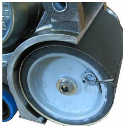
Se, dopo aver eseguite le operazioni di cui sopra, l'abrasivo non fosse teso in modo uniforme, si devono ripetere le operazioni regolando opportunamente l'introduzione dell'abrasivo fino ad ottenere la corretta uniformità di tensione.
