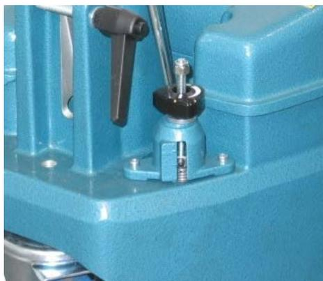
1. Ruotando il volantino in senso orario la pressione del rullo sul pavimento diminuisce.
