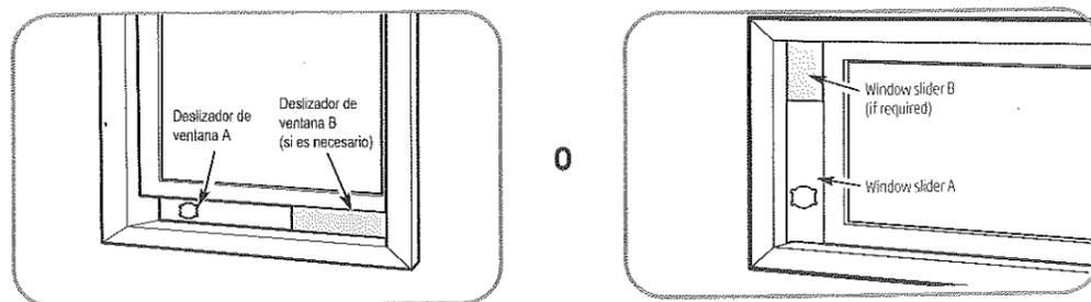
2. Insertar el conjunto deslizador de la ventana en la abertura de la ventana.
