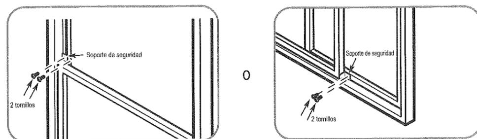
4. Si lo desea, instale el soporte de seguridad con 2 tornillos como se muestra.
