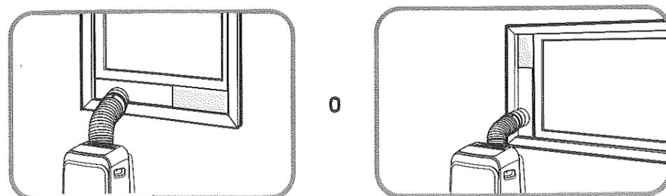
5. Inserte el adaptador de ventana deslizante en el agujero del deslizador de la ventana.
