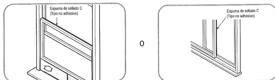
3. Cortar la tira de sellado de espuma de C no adhesiva para que coincida con la anchura de la ventana. Insertar el sello entre el cristal y el marco de la ventana para evitar que el aire e insectos se introduzcan en la habitación.
