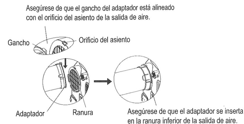
Paso tres: Preparación del deslizador de la ventana ajustable
