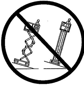
No eleve **NUNCA** la plataforma, ni desplace la máquina con la misma elevada, a menos que aquélla se encuentre sobre una superficie firme y nivelada.
