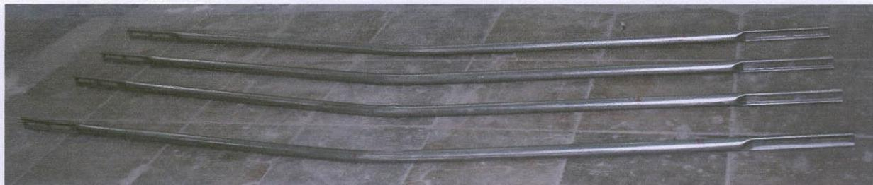
Fotografía nº 10.- Barandillas tras los ensayos. Combinación 1.
