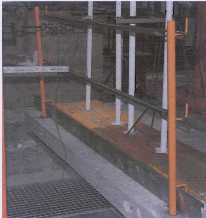
Fotografía nº 7.- Disposición del ensayo de flecha. Combinación 2.
