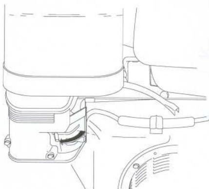
3. Tirar un poco hacia atrás la palanca del acelerador (6).
