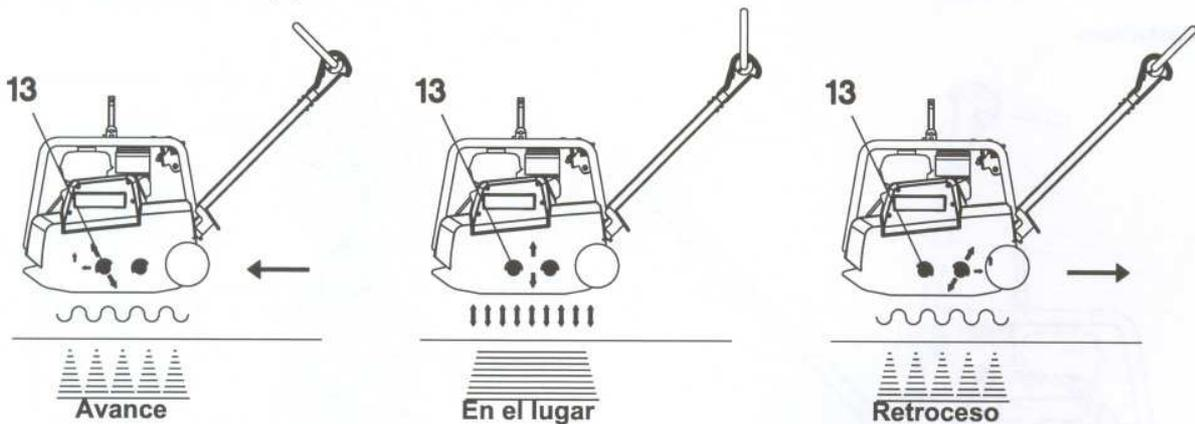
El excitador (5) es impulsado por medio del motor de accionamiento (1), el cual se encuentra solidamente fijado a la masa superior (3). El par motor es transmitido a través del embrague centrífugo (9) a la correa en V (10) al excitador (12).
