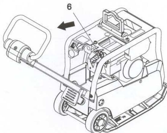
4. Poner el interruptor del motor en la posición „I“.
