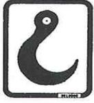
Indicación punto de levantamiento solo del motor.
