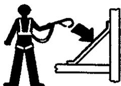
Los ocupantes de la máquina deben usar amés o cinturón de seguridad de acuerdo a los reglamentos de gobierno. Enganche la cuerda de seguridad al punto de anclaje de la plataforma.
