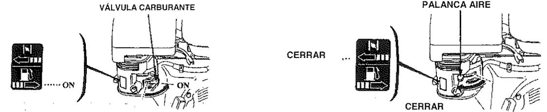
NOTA: No use la palanca del aire si el motor está caliente y la temperatura del aire suficientemente elevada.
