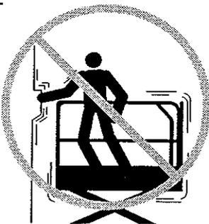
No modifique ni inutilice en modo alguno los componentes de seguridad y estabilidad de la máquina.
