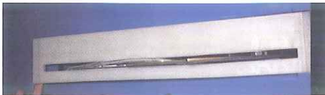
Fig. 7-9 Levantar el Resguardo de la Ranura de la Mesa
