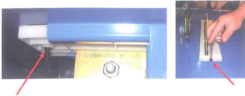
Fig. 7-7 Tornillo del Resguardo de la Ranura de la Mesa
