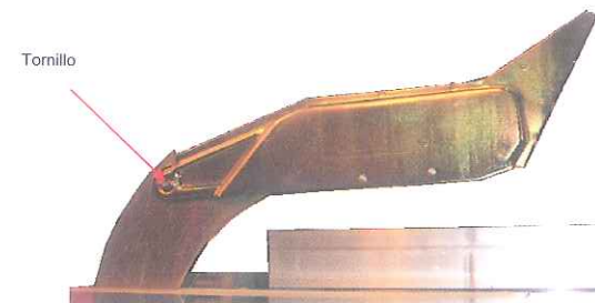
Fig. 7-5 Protector de Disco levantado
