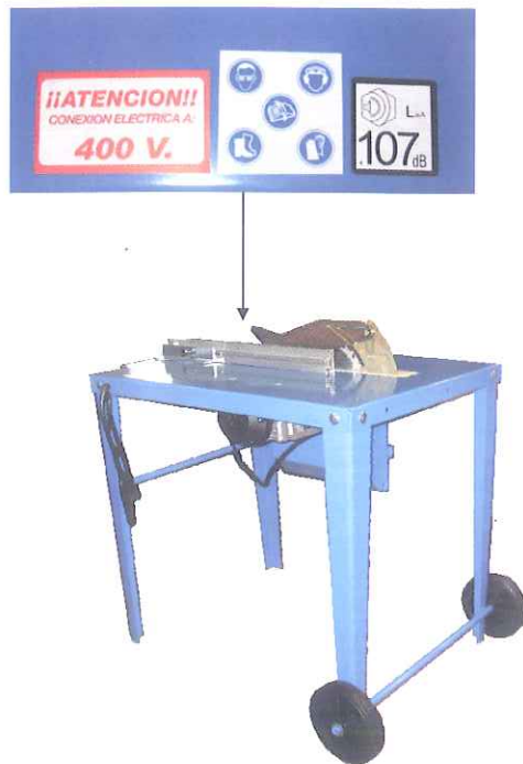
Fig. 5-6 Localización de las advertencias de seguridad
