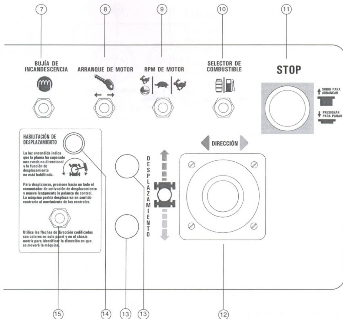
12 Palanca de control proporcional para la función de desplazamiento y pulsador oscilante para la función de dirección O palanca de control proporcional de dos ejes para las funciones de desplazamiento y dirección
