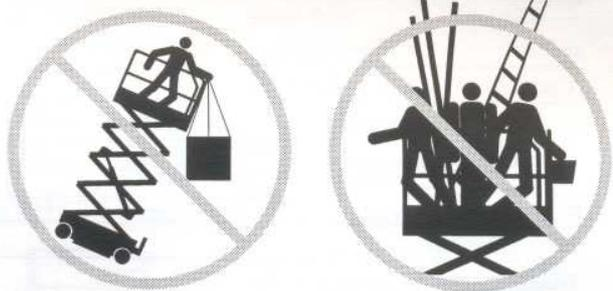
No coloque escaleras ni andamios en la plataforma ni los apoye en ninguna parte de esta máquina.
