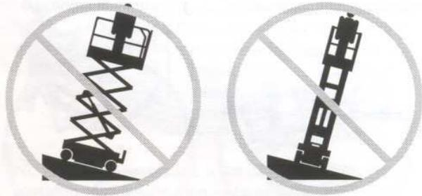
No utilice la alarma de inclinación como indicador de nivelación. La alarma de inclinación instalada en el chasis sólo suena cuando la máquina se encuentra en una pendiente.
