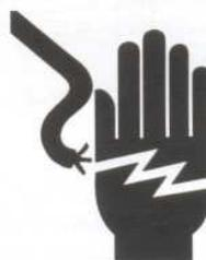
Conecte el cargador de baterías únicamente a una salida de CA de 3 cables con toma de tierra.
