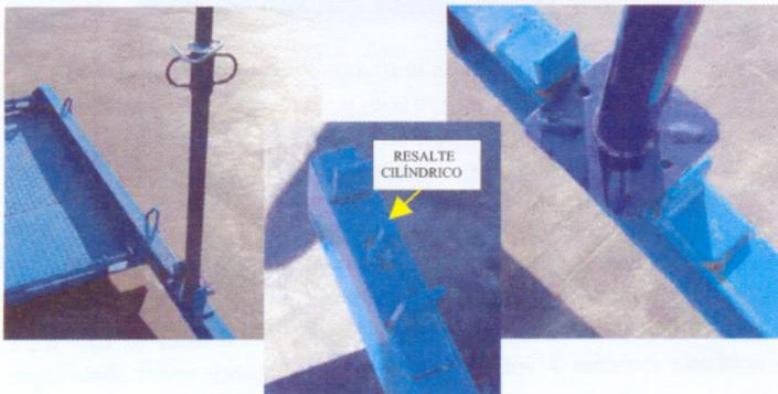
Los puntales deberán ir perforados por la parte inferior de su base para acoger el resalte cilíndrico que les impide su movimiento.
